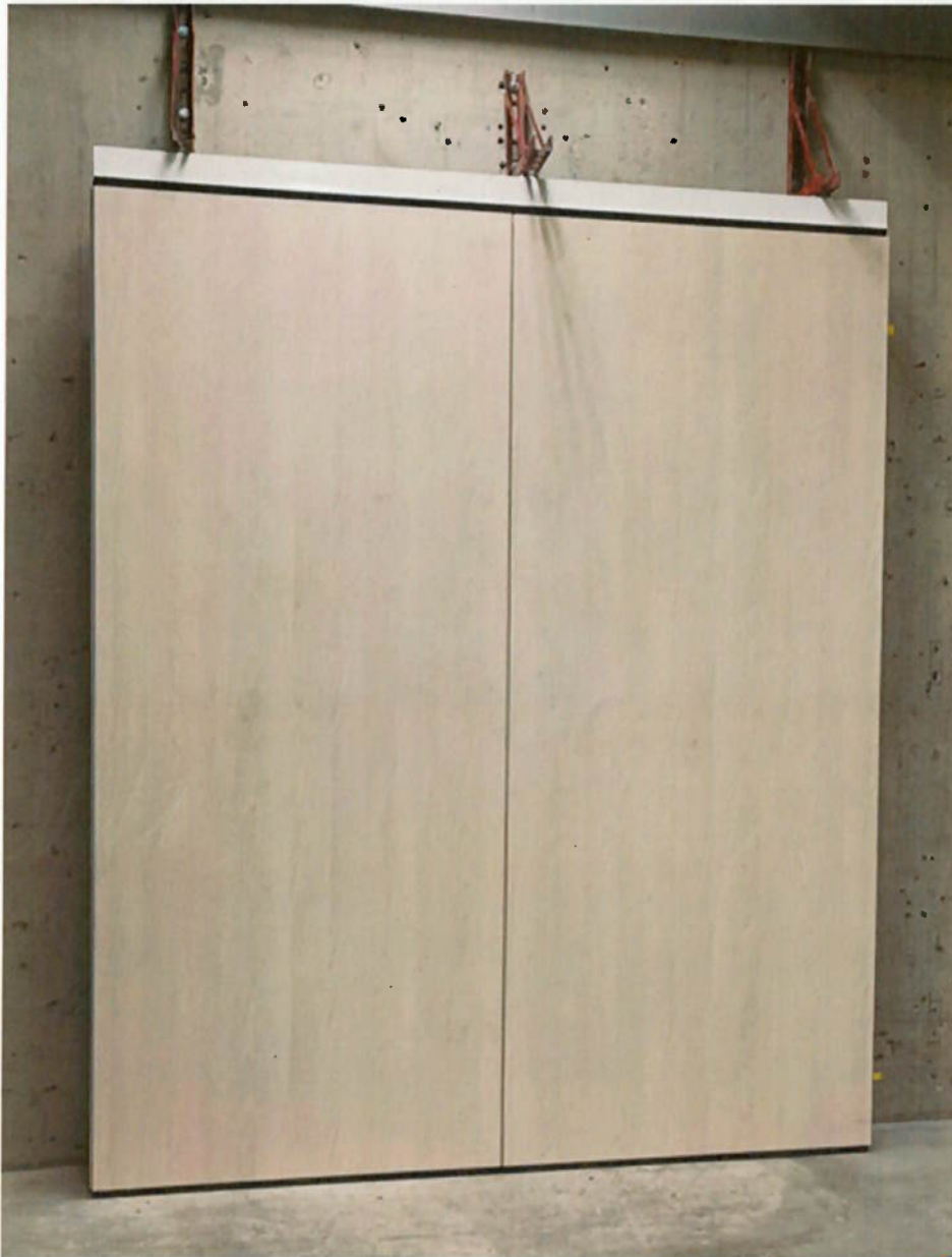
Bild 1 Gesamtansicht: Sichtseite Trennwandsystem "Dorrflex"
